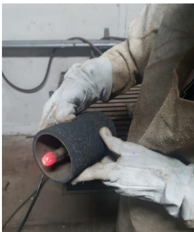
Figura 7 – Eixo preenchido de solda
