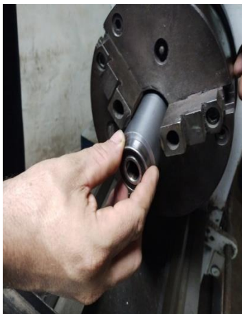
Figura 6 – Verificação do encaixe no diâmetro do rolamento
