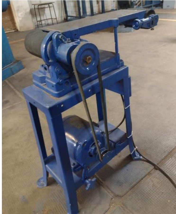
Figura 2 – Lixadeira de Cinta antes da reforma
