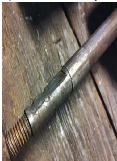
Figura 5 – Eixo da roda desgastado
