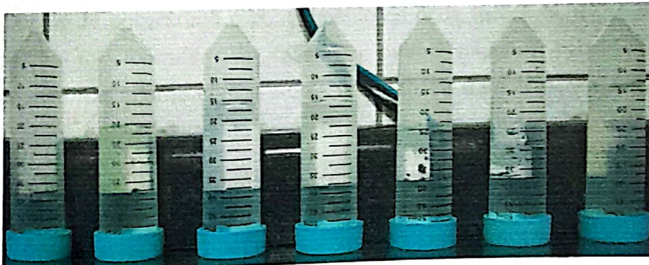
Figura 9.4 Concentrações de Formazina, respectivamente em: 4, 20, 50, 80, 120, 160 e 200 NTU.
