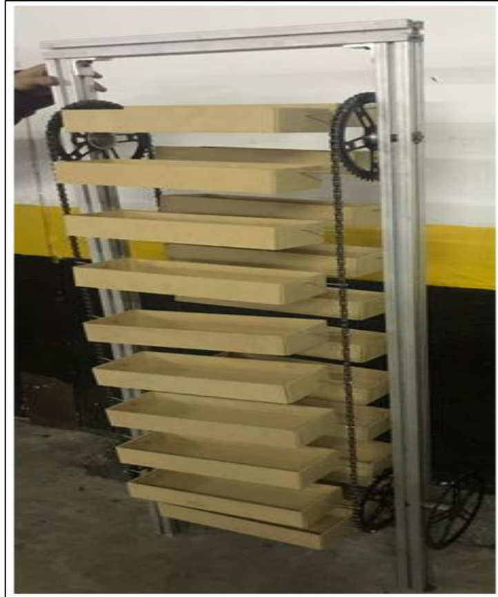
Figura 3.7 – Estrutura com as calhas fixadas
