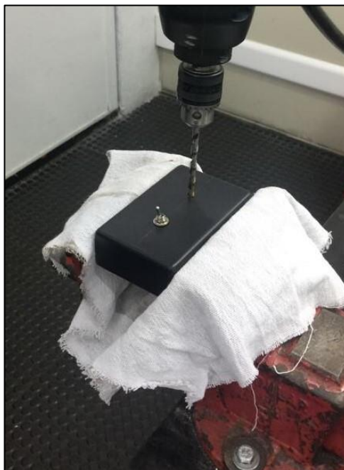
Figura 3.11 – Furações no gabinete e colocação das interfaces
