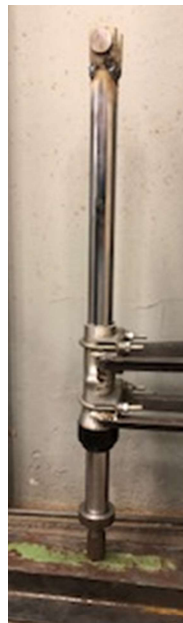
Figura 8: Pistão / Bengala de amortecedor de moto
