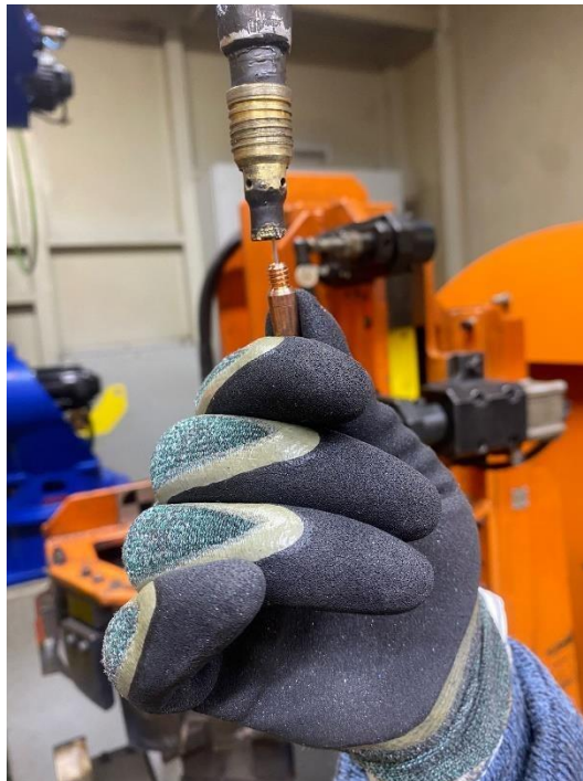
Figura 1: Troca manual do Bico
