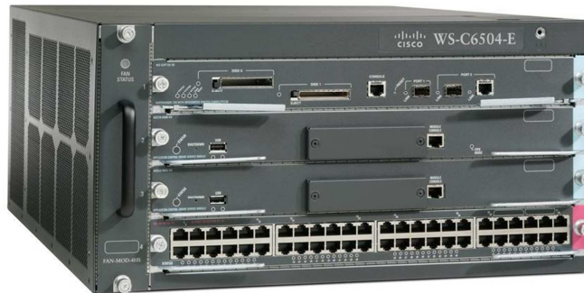
Figura 4. Switch Cisco modelo WS-C6504-E.
