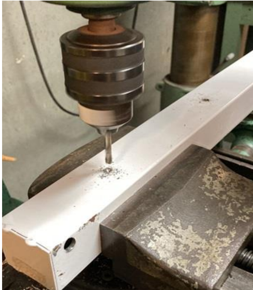
Figura 9: Furos para fixação do motor elétrico Fonte: Dispositivo móvel
