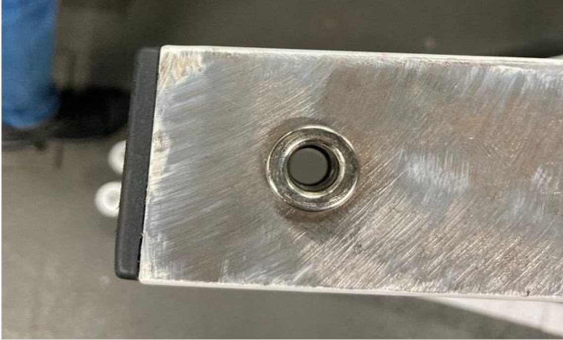
Figura 10: Furo passagem do cabo de aço do motor elétrico Fonte: Dispositivo móvel
