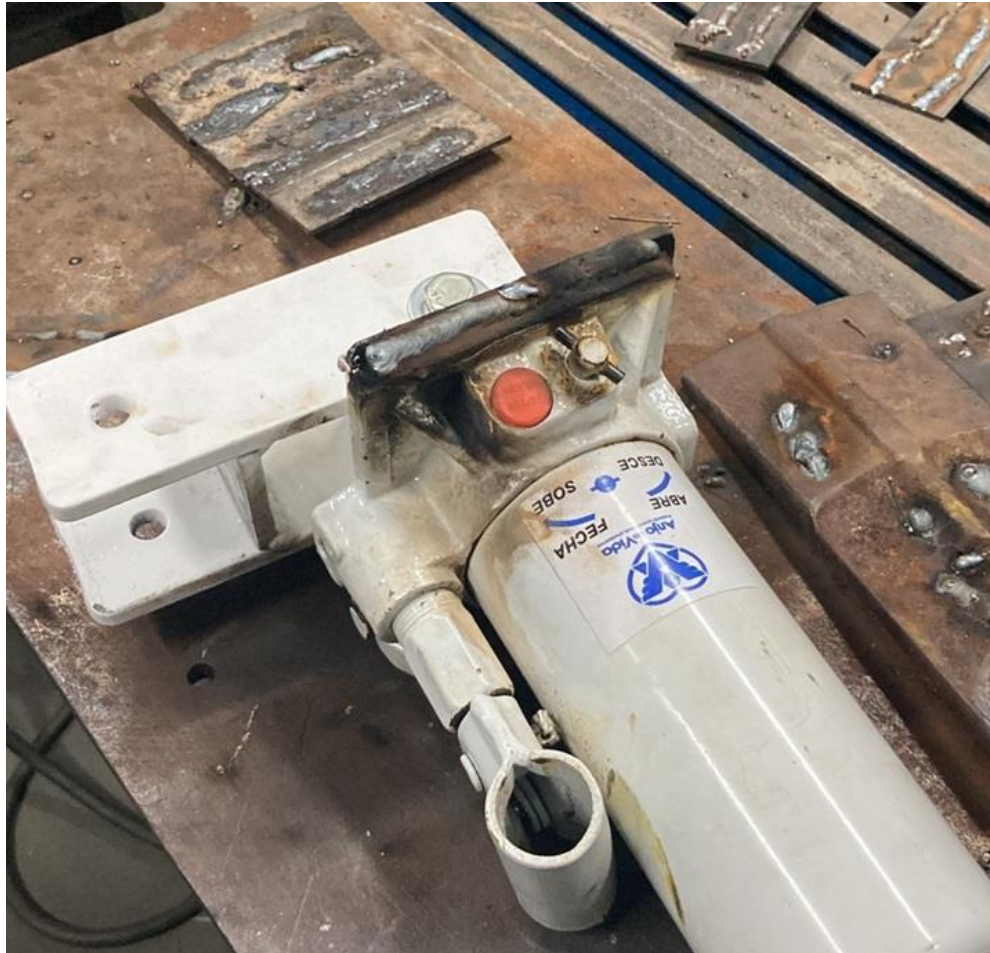
Figura 8: Solda entre a base do pistão hidráulico e o acionador do pistão Fonte: Dispositivo móvel
