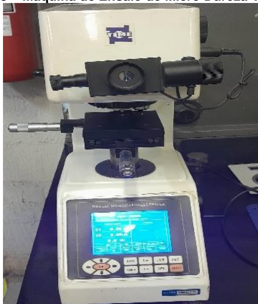
Foto 5 – Máquina de Ensaio de Micro Dureza Vickers
