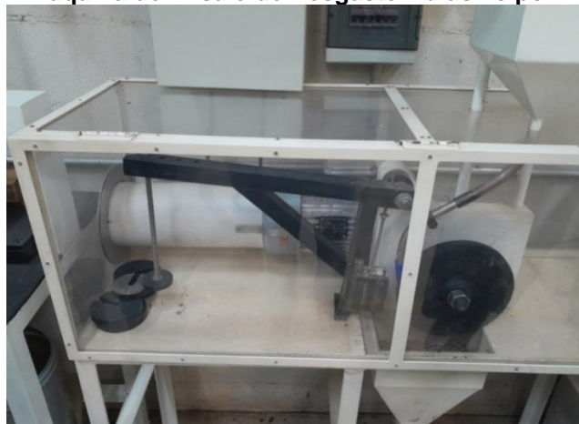
Foto 4 – Máquina de Ensaio de Desgaste Abrasivo por Borracha
