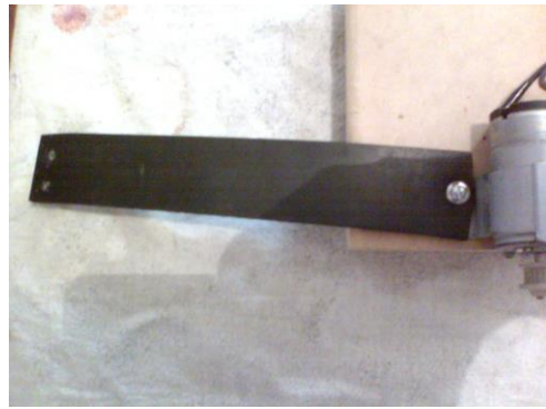
Figura 19 - Fixação da fita de borracha para prender o gerador
