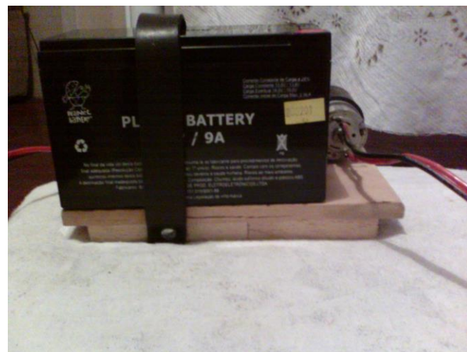
Figura 24 - Parafuso prendendo a tira de borracha
