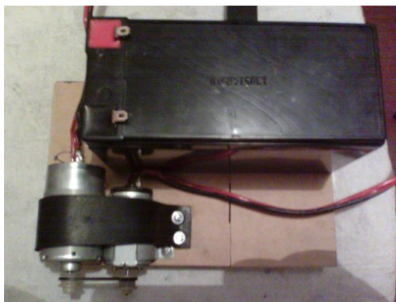
Figura 22 - Alocação da bateria na chapa
