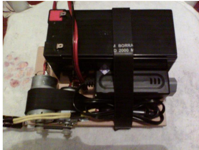
Figura 23 - Fixação da bateria e do inversor através da tira de borracha
