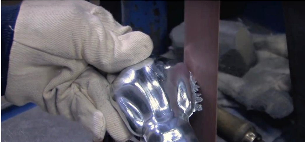
Figura 2- Peça soldada com rebarba
