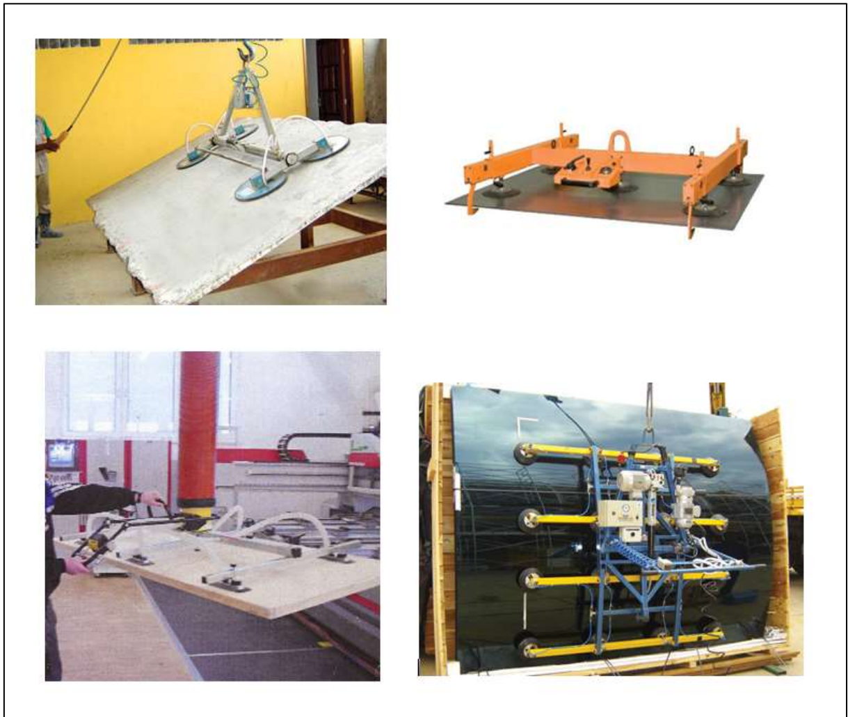
Figura 15: Sugestão para o levantamento de carga e aplicação de força - ventosa
