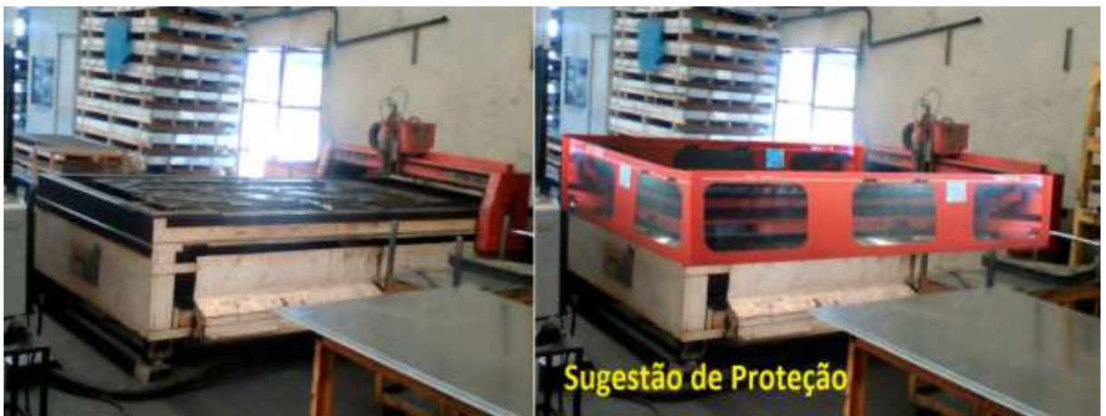
Figura 13: Sugestão para a proteção para o risco de acidentes para o corte à plasma
