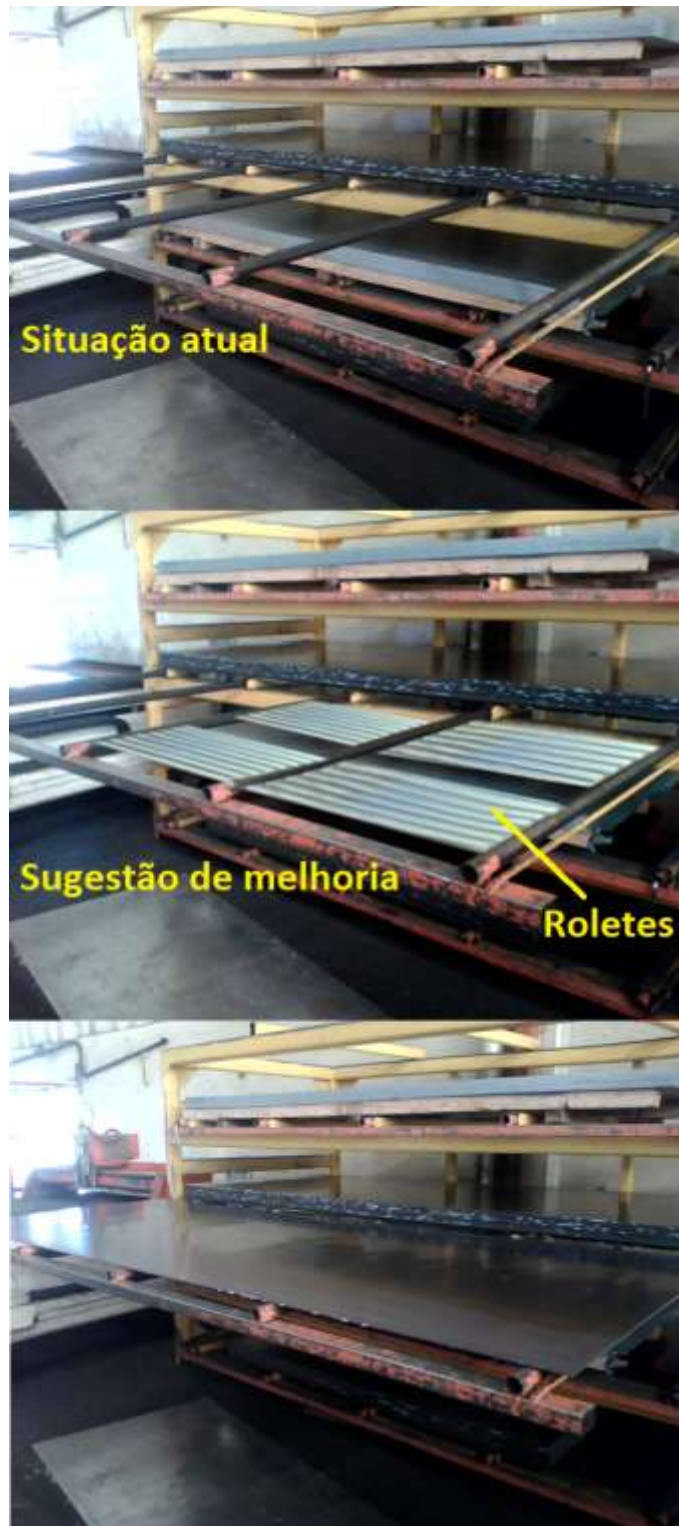
Figura 11: Sugestão de melhoria para levantamento de carga para o corte à plasma
