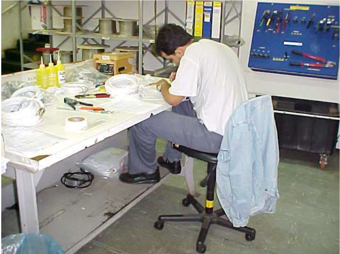
Figura 2: Bancadas com apoio para os pés com altura incorreta
