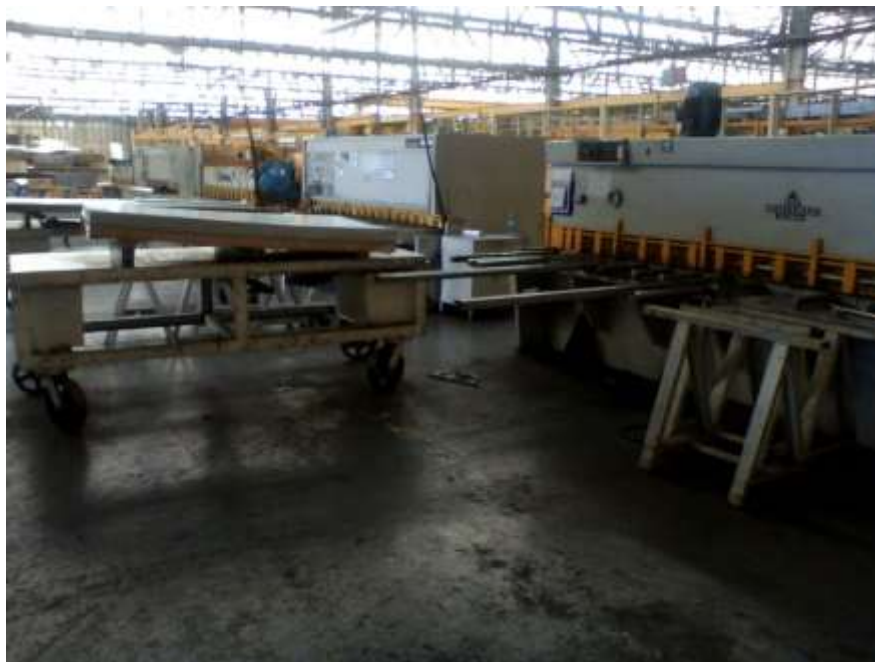
Figura 4: Setor de corte de chapa com a guilhotina
