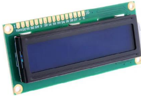
Figura 4 – Display LCD 16x2 Backlight Azul.
