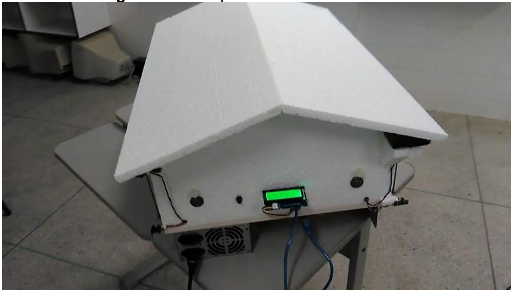
Figura 2: Protótipo do Aviário Automatizado
