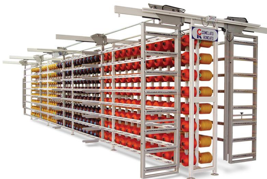
Imagem 5: Gaiola com 80 Posições por Quadro.
