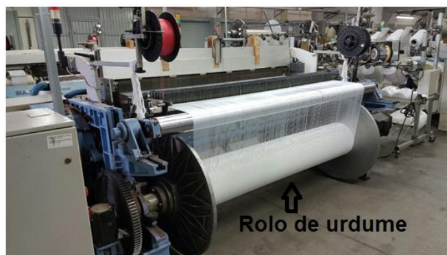
Imagem 3: Tear Carregado com Rolo de Urdume.
