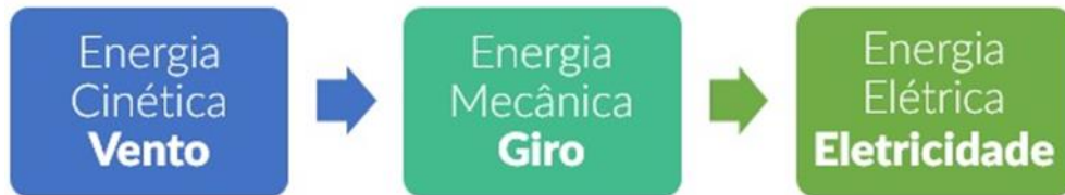
Figura 4: Transformação de energia
