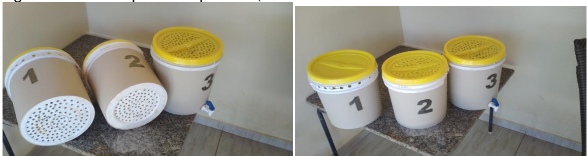
Figura 01: Baldes para composteira, com mostra onde os furos foram feitos.
