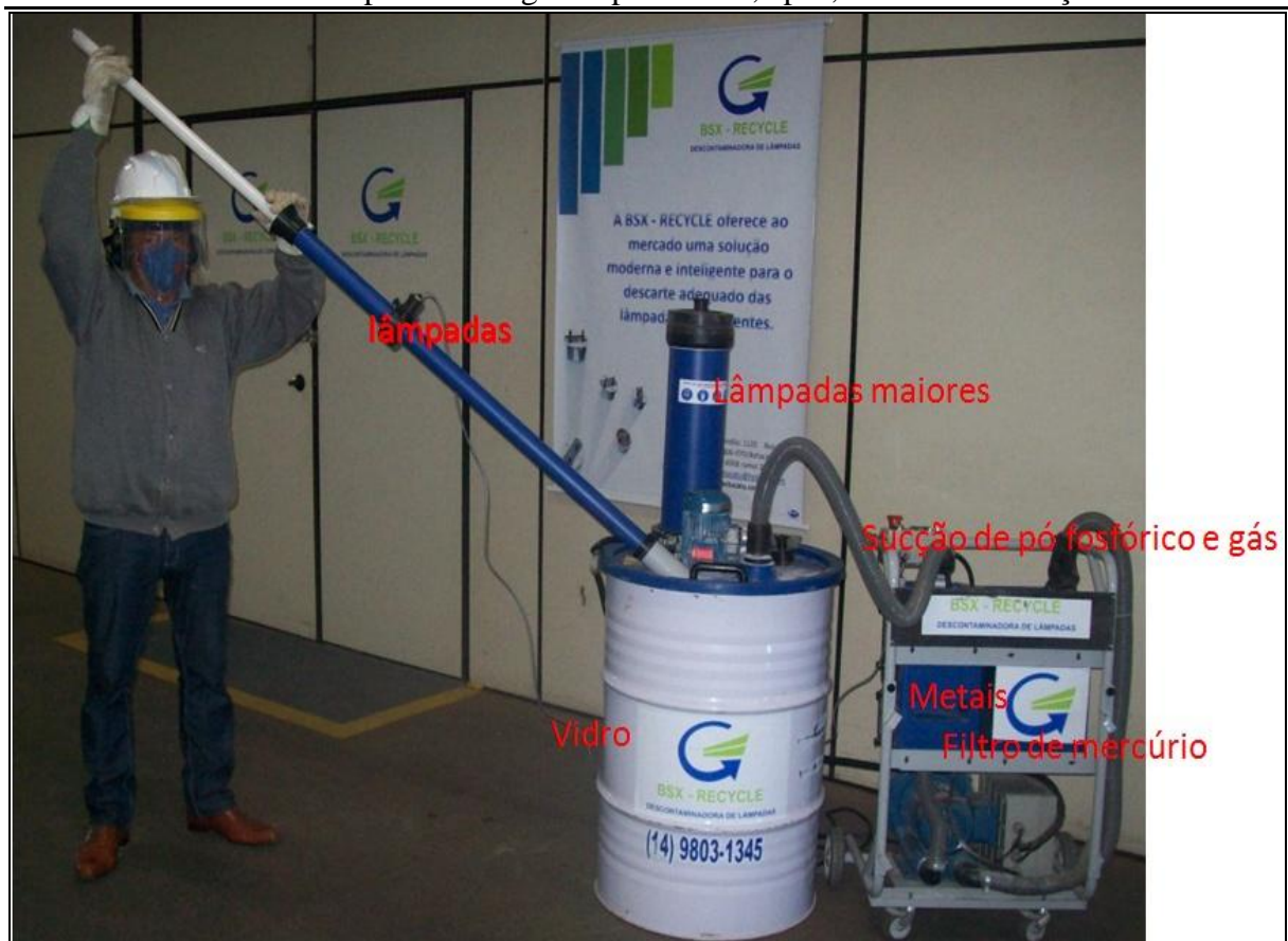
Figura 5 - Máquina descontaminadora de Lâmpadas com demonstração aonde são separados os materiais para reciclagem e para reuso, após, a descontaminação
