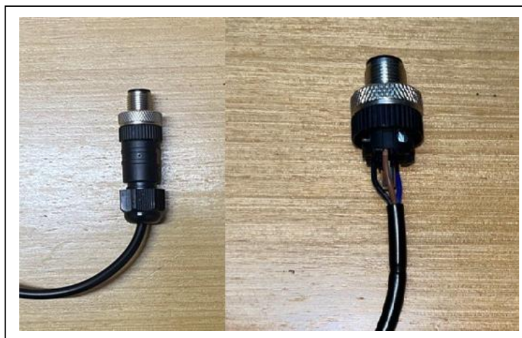
Figura 3.10 - Montagem do conector ao cabo do sensor
