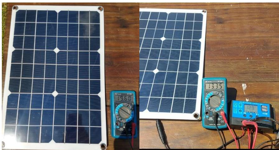
Figura 8 – Ensaio de tensão painel fotovoltaico
