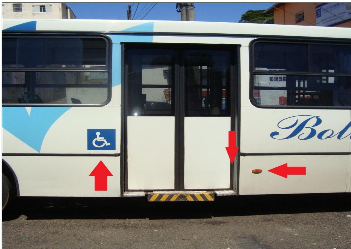
Conforme NBR 14022, os veículos deverão primeiramente estar identificados com o SIA, à plataforma de elevação deverá estar pintada ou encapsulada com a cor amarelo munsell para uma melhor visualização do equipamento, também deverá estar uma luz piscante localizada e sinal sonoro intermitente próximo da plataforma. Dispositivos esses deverão ser acionados durante a operação de embarque e desembarque com a utilização do elevador.
