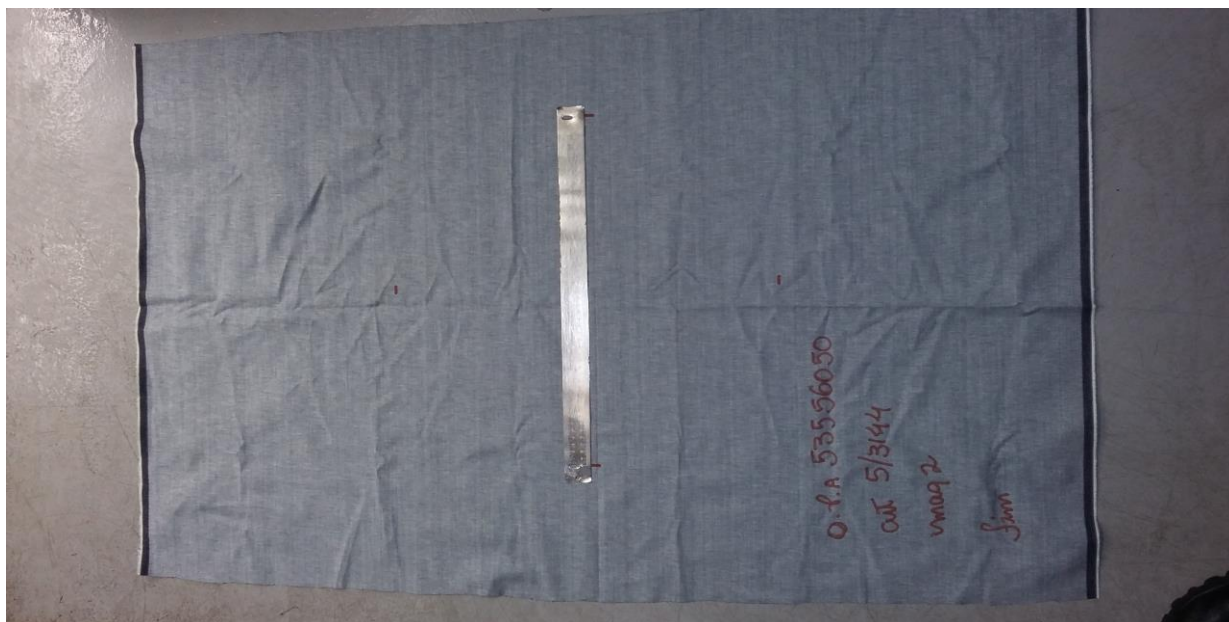
Figura 17 - Tecido feito marcação antes de ser lavado conforme normas
