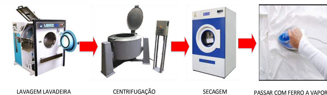
Figura19 -Procedimento de lavagem de tecidos para teste de encolhimento conforme norma ABNT
