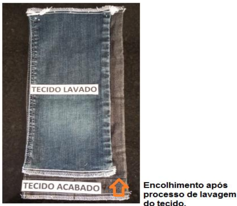
Figura 3- Defeito encolhimento de urdume fora da especificação
