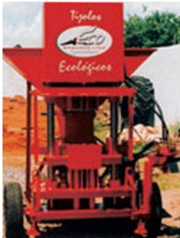
Figura 5 - Máquina de Tijolos Ecológicos
