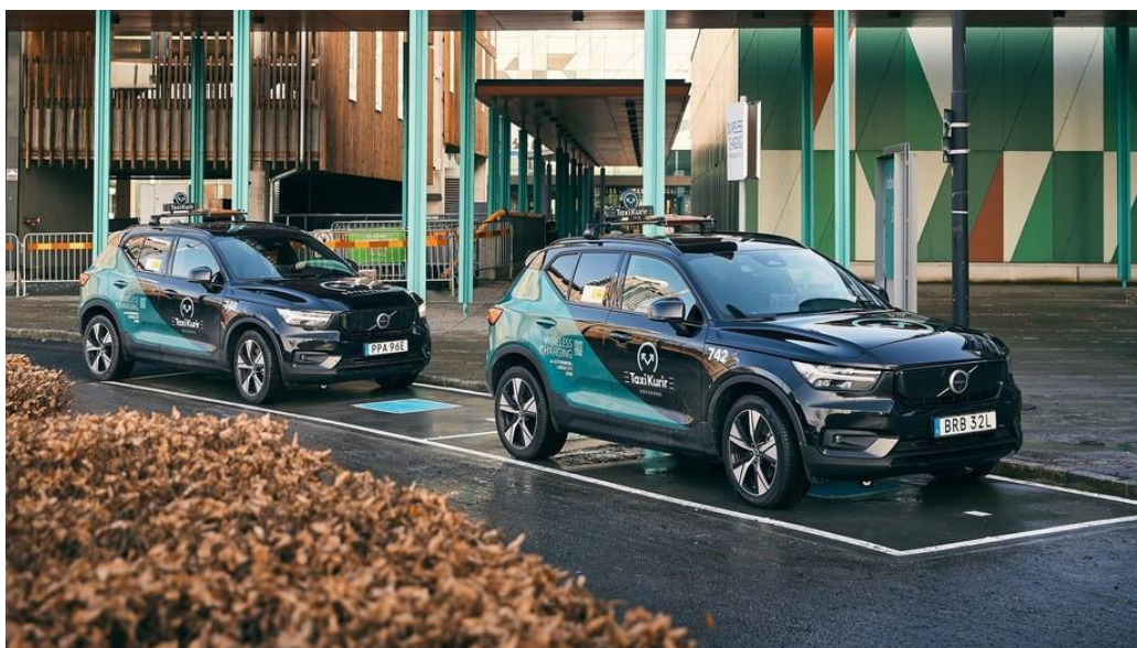
Figura 62: Teste de recarga sem fio indutiva realizada pela Volvo
