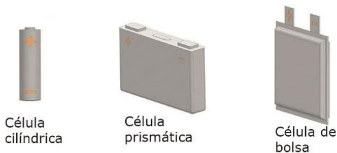
Figura 08: Tipos de formatos de células de baterias de íon de lítio
