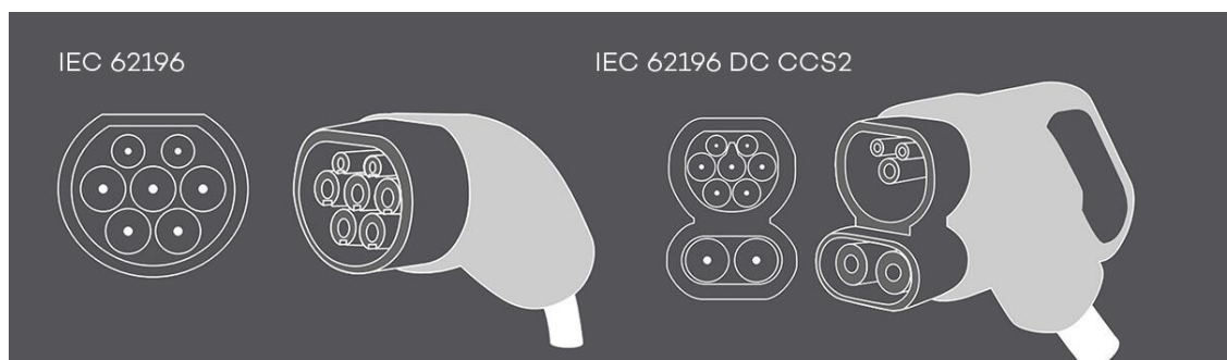
Figura 45: Padrões tipo 2 (IEC 62196) e tipo 2 combinado CCS2
