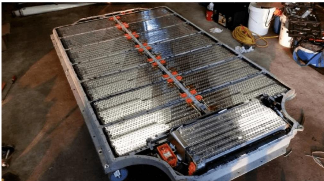
Figura 11: Bateria de íon de lítio da Tesla
