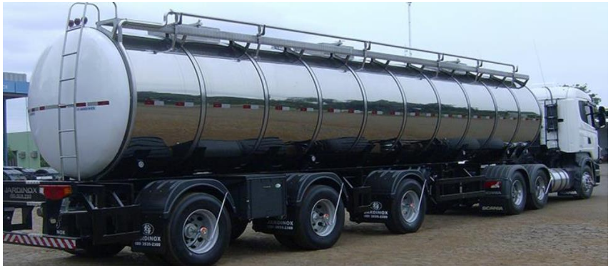
Figura 1: Tanques Rodoviários Isotérmicos
