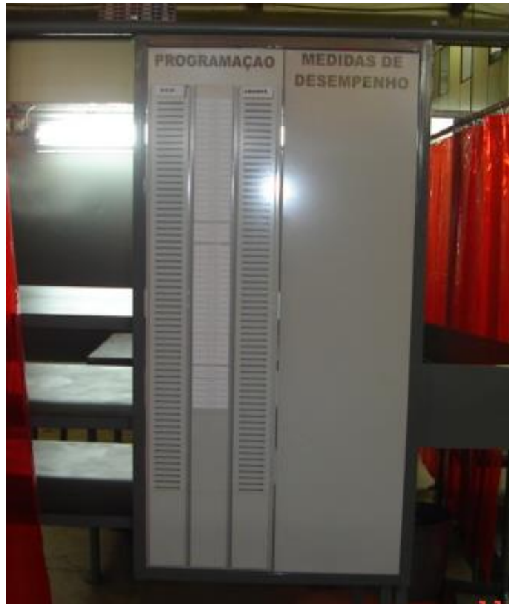
Figura 16 - Quadro de kanban da solda
