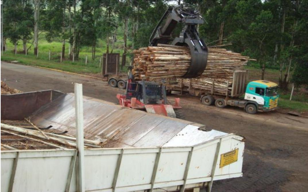
Figura 20 - Caminhão sendo descarregado na mesa alimentadora do picador de toras.
