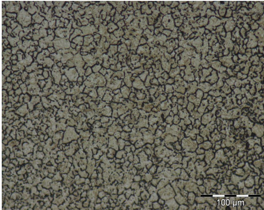
Figura 39 Microfotografia da amostra do LOTE A com ataque combinado
