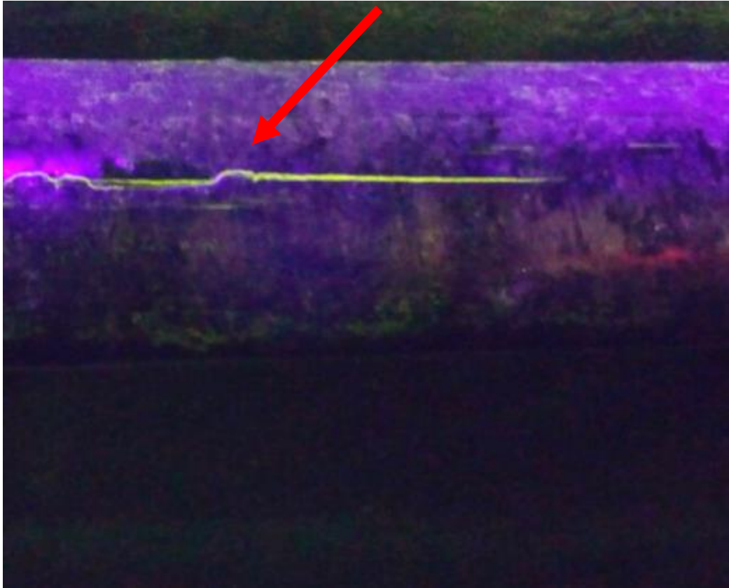
Figura 14 - Trinca enraizada de aciaria
