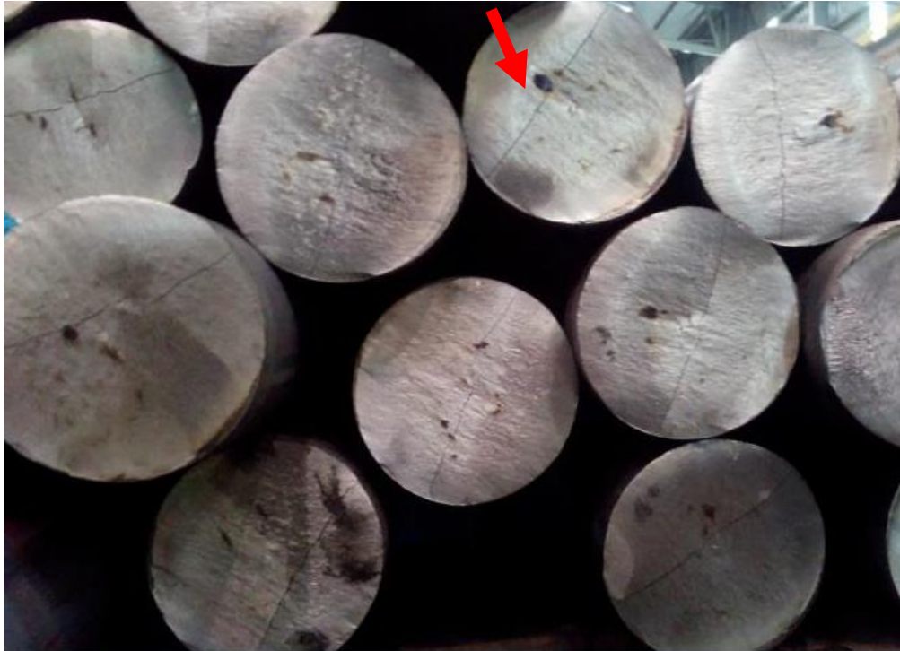
Figura 19 - Trinca de topo
