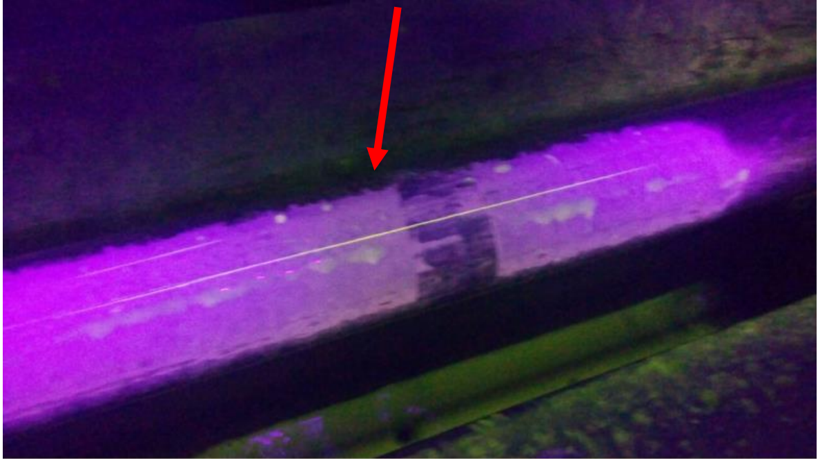
Figura 16 - Trinca de laminação.
