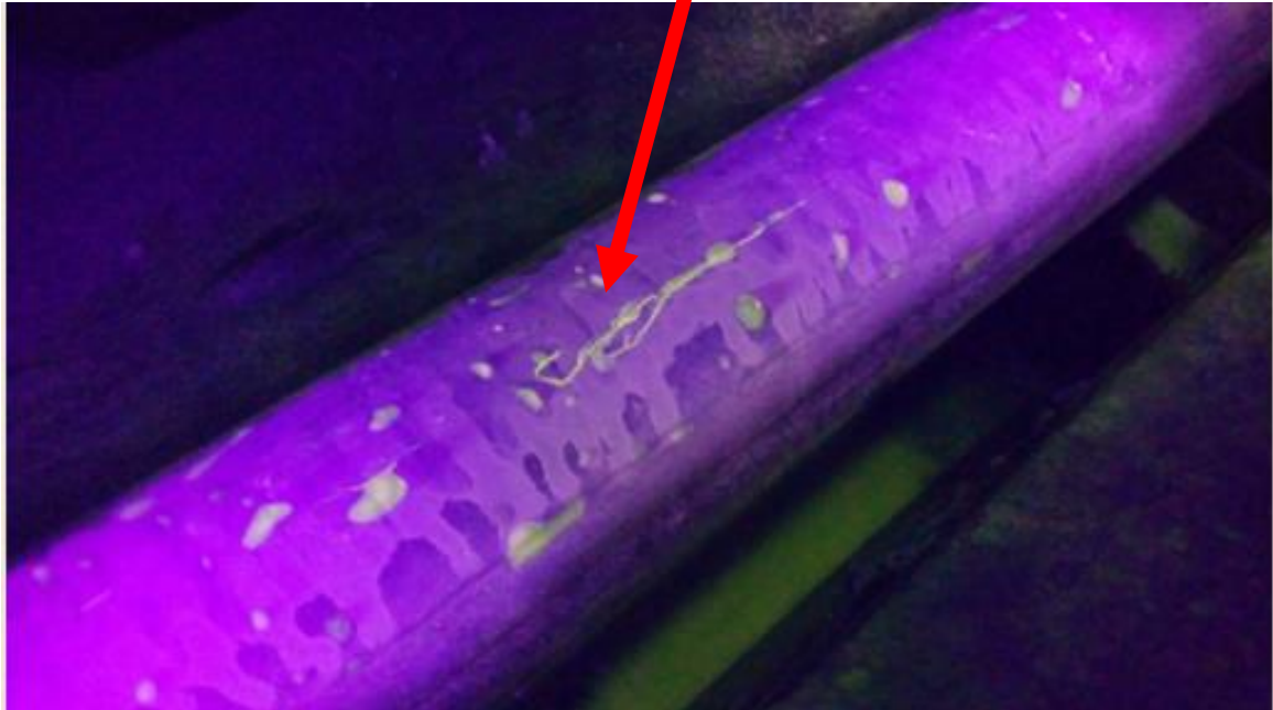
Figura 7 - Escama de laminação
