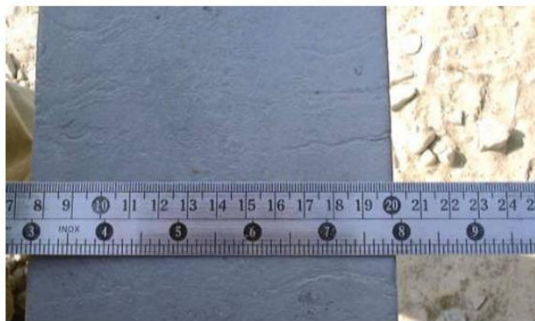
Figura 4 - Aspecto de uma trinca transversal em um tarugo
