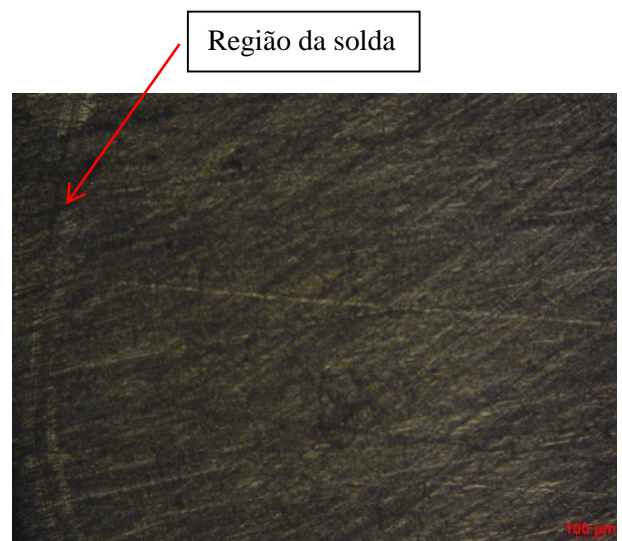
Figura 25. Amostra de inox 316 não imersa – região da solda e zta com ampliação de 50 X.
