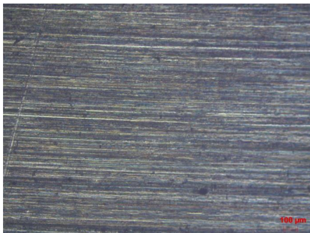
Figura 33. Amostra de inox 304 não imersa com ampliação de 50 X.
