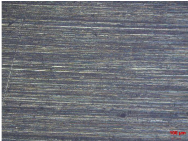
Figura 18. Amostra de inox 304 não imersa com ampliação de 50 X.
