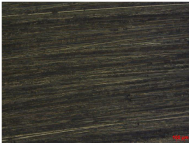
Figura 46. Amostra de inox 321 não imersa com ampliação de 50 X.
