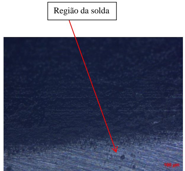
Figura 41. Amostra de inox 316 imersa – região da solda com ampliação de 50 X.
