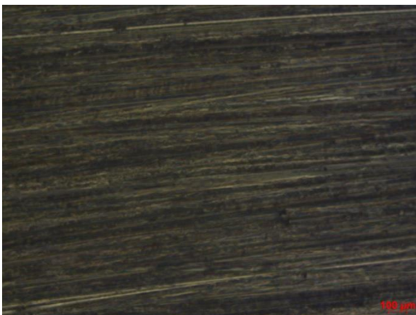
Figura 29. Amostra de inox 321 não imersa com ampliação de 50 X.
