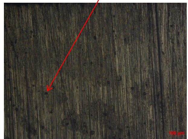
Figura 45. Amostra de inox 321 não imersa – região da solda com ampliação de 50 X.
