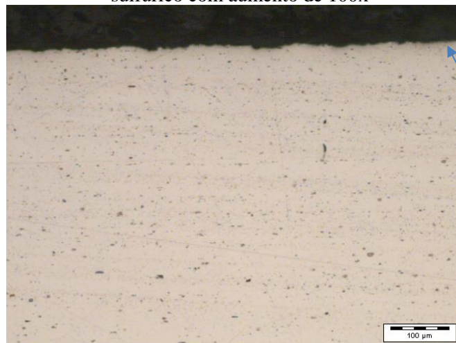
Figura 16: Mostra o metal de base da amostra não sensibilizada após teste de corrosão em ácido sulfúrico com aumento de 100x
