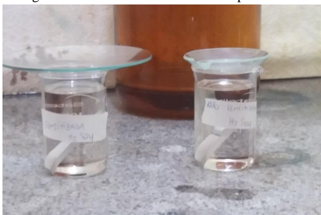
Figura 12: Banho em ácido sulfúrico por 24 horas
