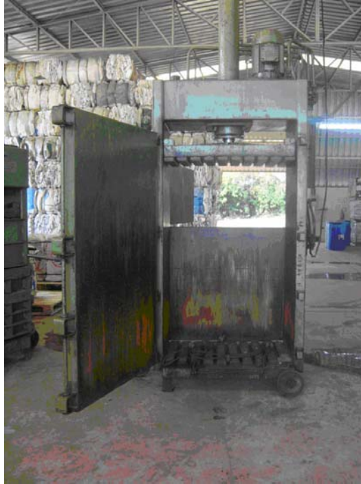
Figura 24. Equipamento para prensagem das embalagens.
