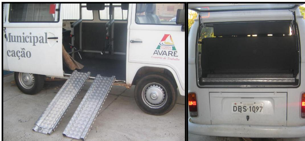
Figura 13. Foto de Plataforma dupla ajustável removível para cadeira de rodas.
