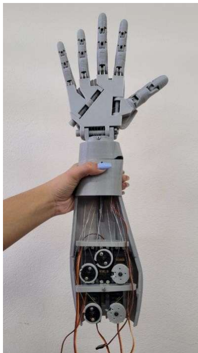
Figura 21: Finalização da junção da mão com o antebraço. FONTE: Arquivo pessoal.
