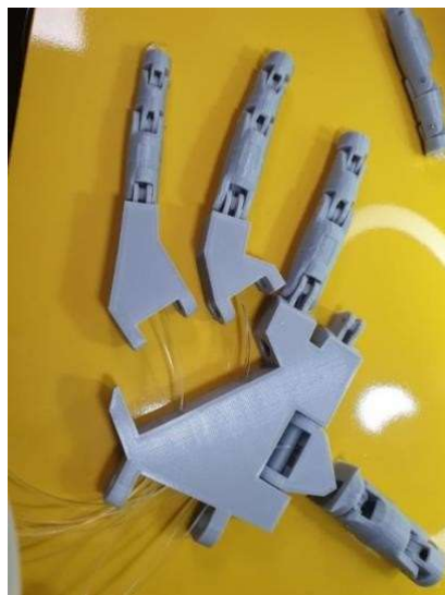
Figura 14: Processo de encaixe dos dedos e palma da mão. FONTE: Arquivo pessoal.
