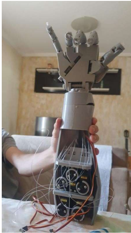
Figura 19: Colagem do antebraço. FONTE: Arquivo pessoal.
