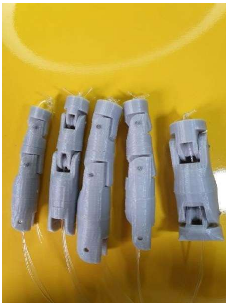
Figura 12: Fios de nylon no interior de cada dedo. FONTE: Arquivo pessoal.
