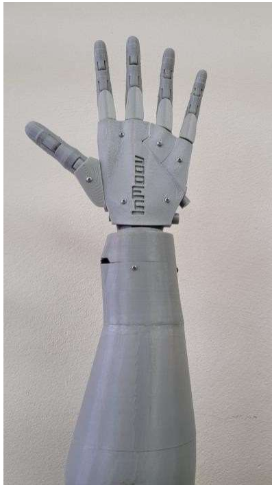
Figura 20: Finalização da junção da mão com o antebraço. FONTE: Arquivo pessoal.
