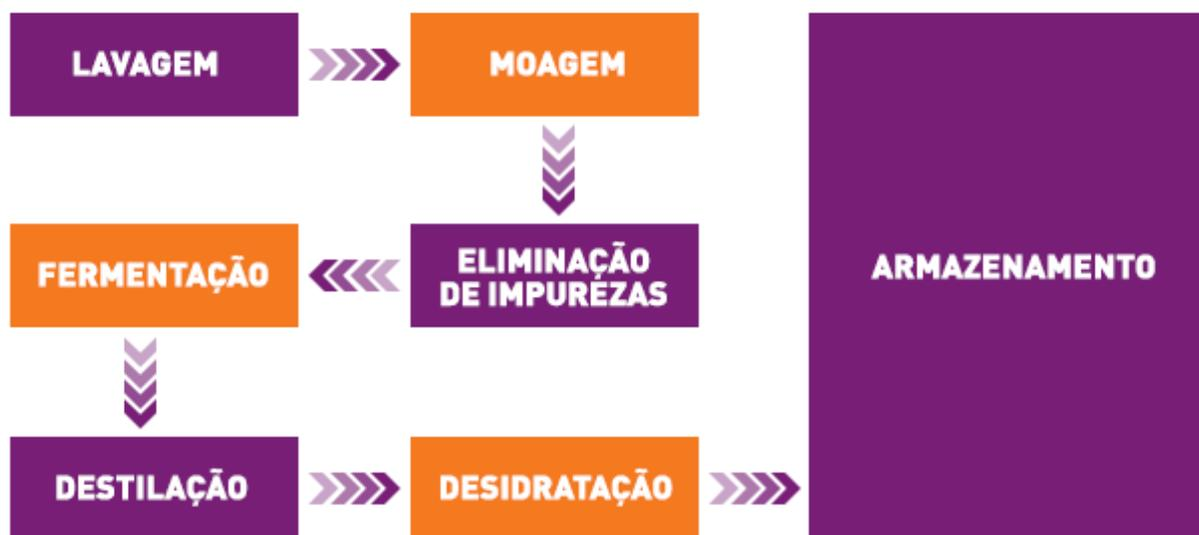
Figura 18. Ilustra o fluxo de produção do etanol.
