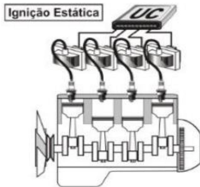
Figura 17. Sistema de ignição estática.
