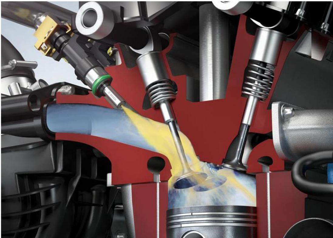
Figura 9. Modelo de um sistema com injeção indireta.
