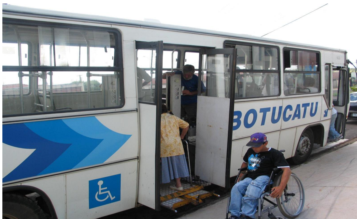
Figura 53. Vista do detalhe do sistema de embarque Fonte: ADEFIB (junho/2008)
