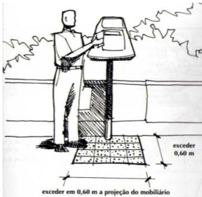
Figura 34. Utilização de piso tátil Fonte: CPA 2003
