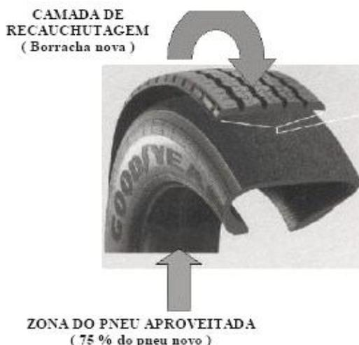
Figura 1. Processo de recauchutagem.
