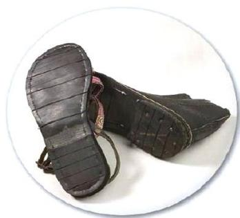
Figura 6. Sapato aplicando a borracha no solado.
