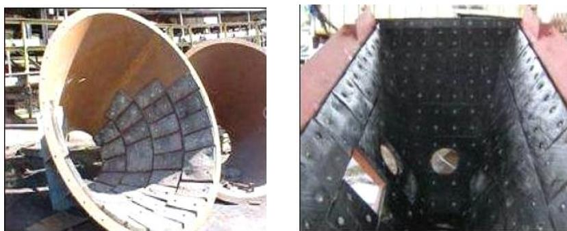
Figura 7. Emprego das placas de borrachas em revestimentos industriais.
