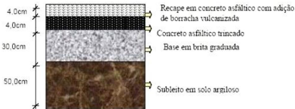
Figura 16. Estrutura representativa do pavimento com adição de borracha vulcanizada.
