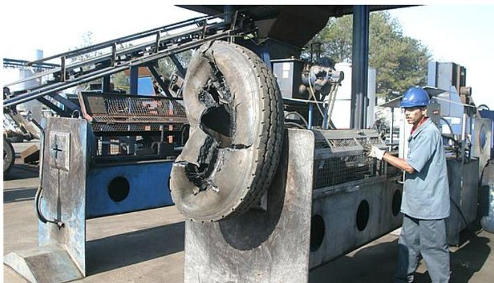
Figura 5. Processo de extração da malha de aço de um pneumático inservível de caminhão.
