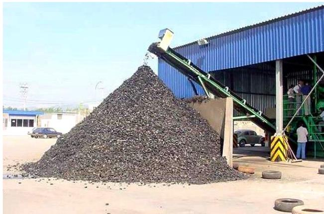
Figura 9. Unidade de trituração – pneumáticos inservíveis já triturados.
