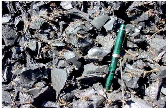
Figura 10. Pneumáticos inservíveis triturados.
