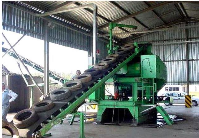
Figura 8. Unidade de trituração – pneumáticos inservíveis ainda não moídos.
