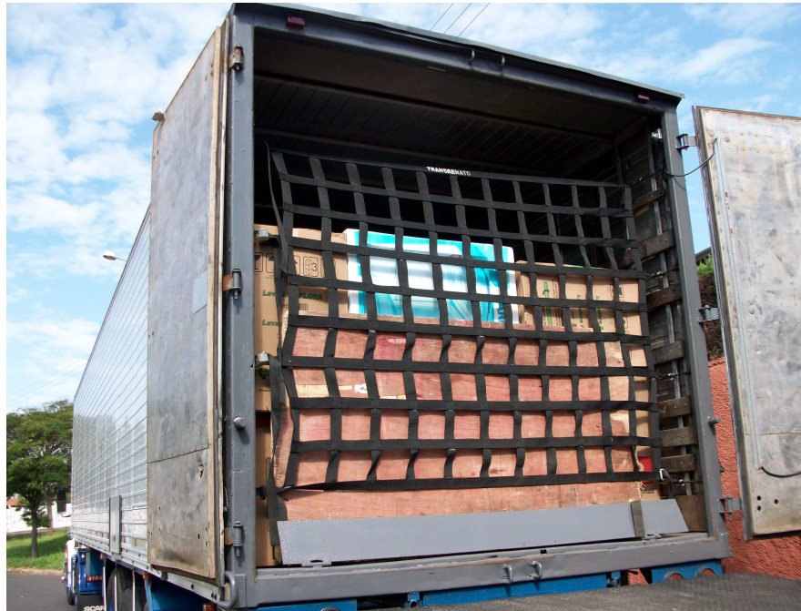
Figura 12. Redes, Madeirites e Amarrações para a separação de cargas. *Fonte: SCHNEIDER, D.M., Botucatu, SP, 2008.
