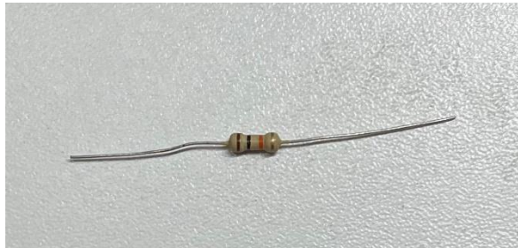
Figura 4 – Resistor 1.000k e +/- 5% de tolerância Fonte: Autoral
