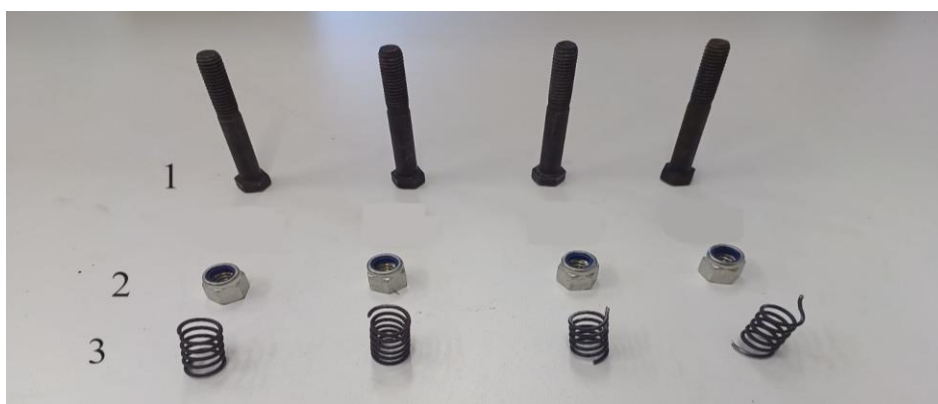
Figura 8 – Parafuso sextavado (1), rosca nylon (2) e molas (3) Fonte: Autoral
