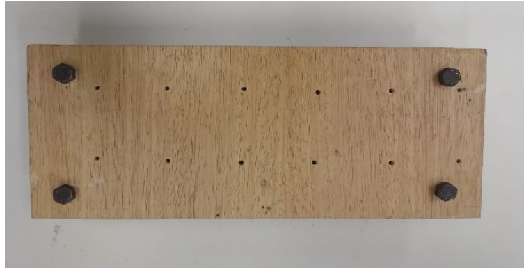
Figura 31 – Estrutura base (união das chapas por meio do conjunto de parafusos e molas) Fonte: Autoral
