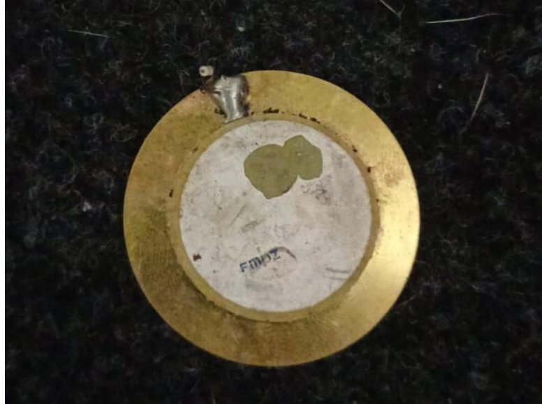
Figura 15 – Disco piezoelétrico danificado devido à alta temperatura Fonte: Autoral
