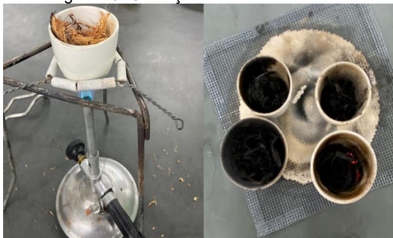
Figura 10. Obtenção do carvão calcinado
