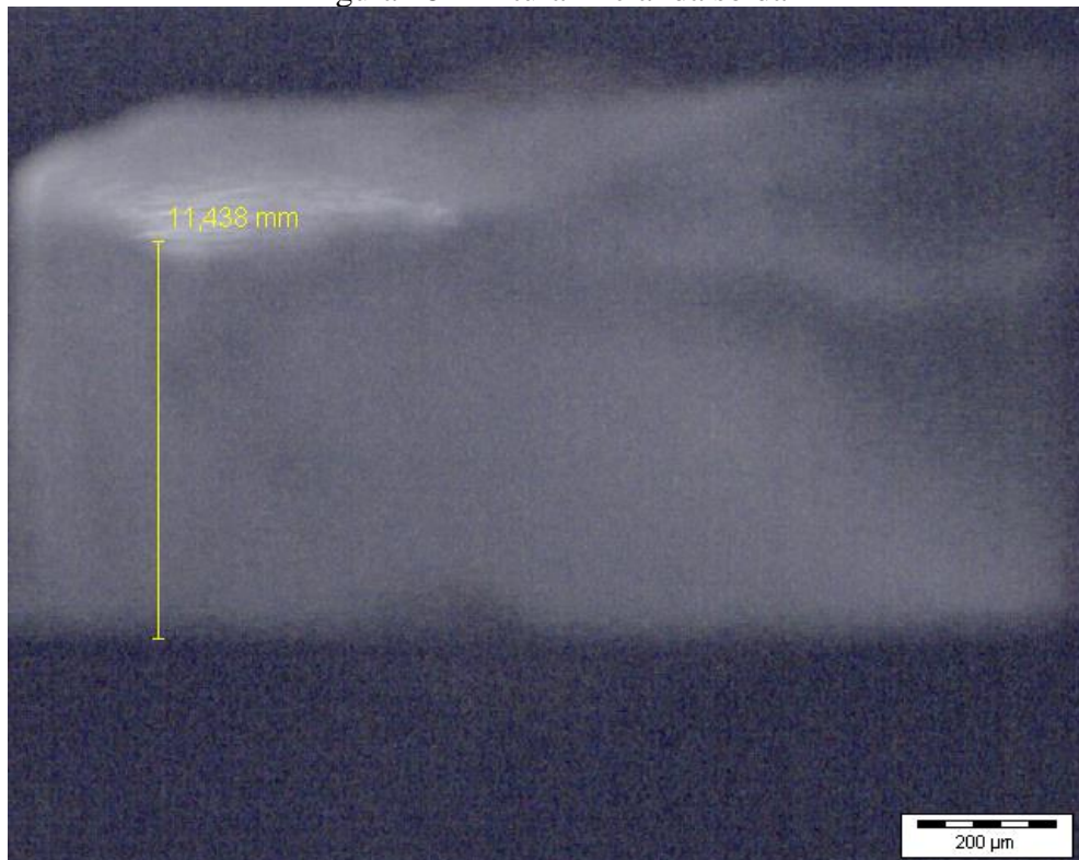
Figura 28 – Altura inicial da solda
