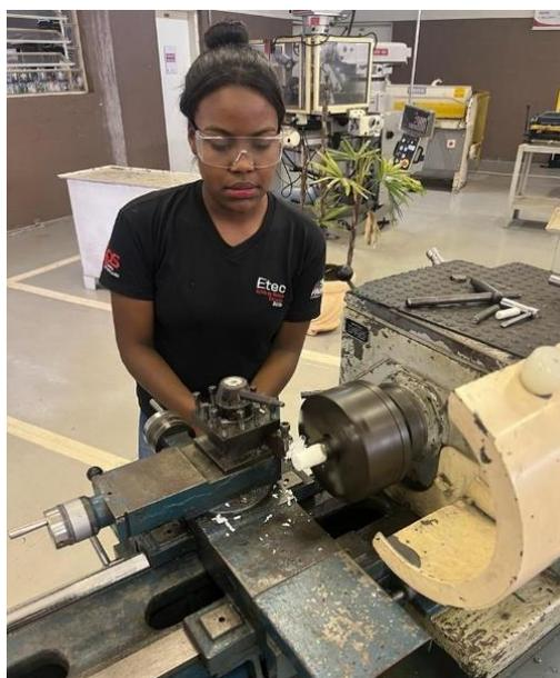
Figura 23: Torneamento do tecnil para encaixe do motor
