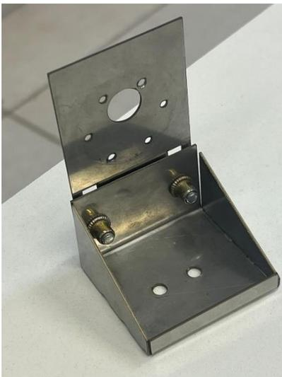
Figura 10: Suporte de aço inox para o motor
