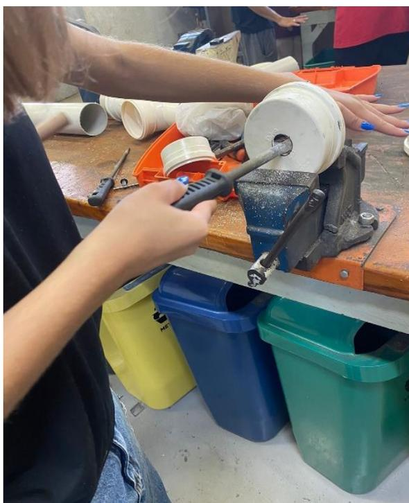
Figura 19: Limando o furo para encaixe da rosca
