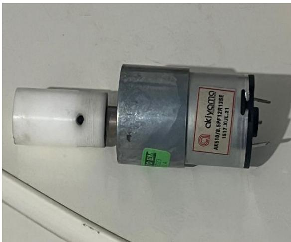
Figura 24: Encaixe do tecnil no motor
