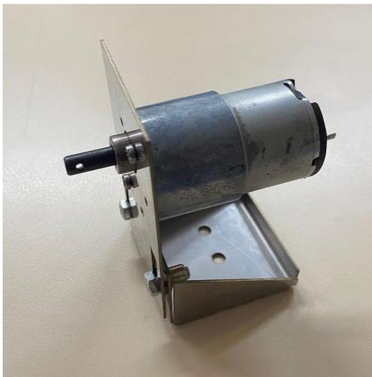
Figura 25: Suporte de fixação do motor
