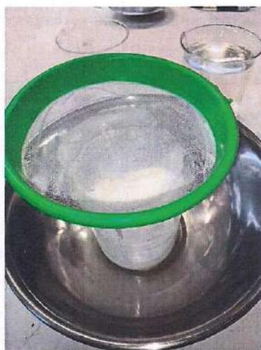
*Figura 23 - Mecanismo de separação do amido (peneira sob béquer dentro do bowl de inox).*
