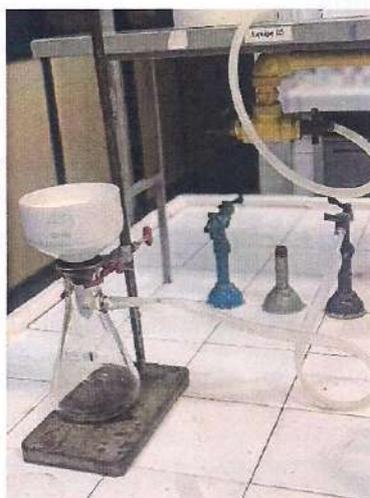
*Figura 25 - Mecanismo de filtração a vácuo.*
