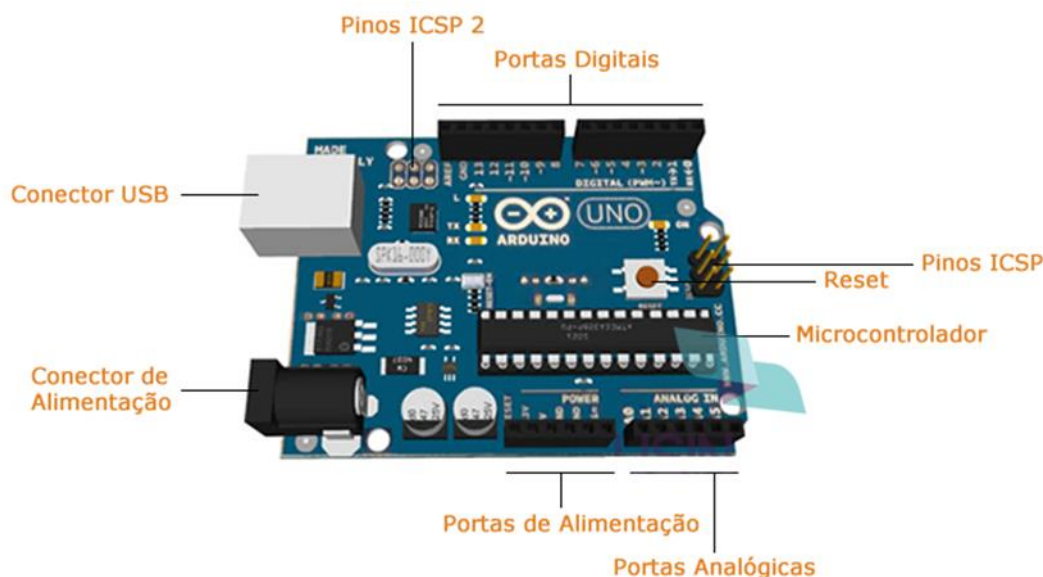
Figura 12 - Arduino UNO
