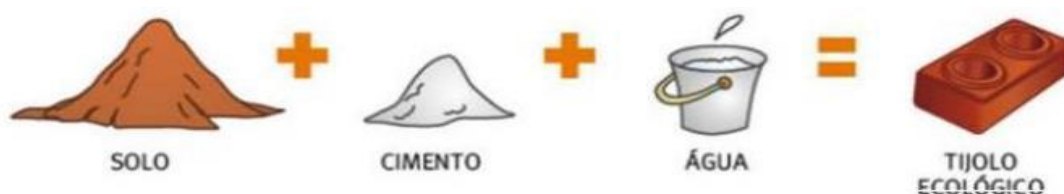
Figura 3 – Composição tijolo ecológico.
