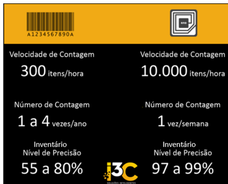
Figura 4 - Dados de níveis de precisão entre código de barra e RFID
