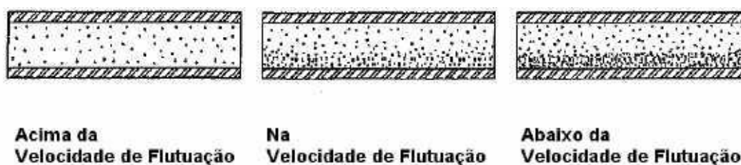
Figura 10: Comportamento do material na tubulação acima, abaixo e na velocidade de flutuação da partícula.
