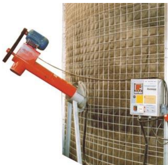
Ilustração 2-Duto(sistema de descarga e ventilação)
