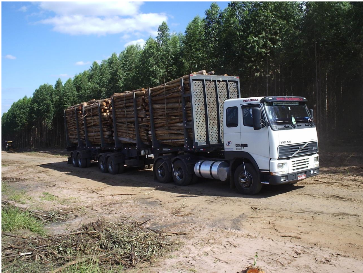
Figura 3- Caminhão tipo bitrem florestal utilizado para o transporte de madeira da área florestal até a fábrica
