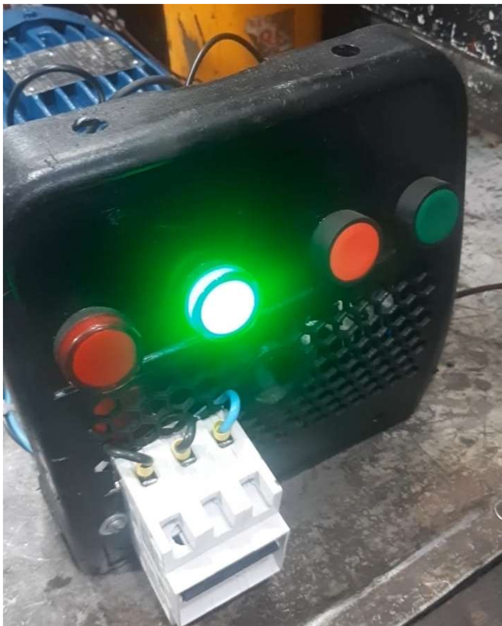
Figura 12: Protótipo funcionando e gerando a terceira fase.
